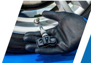
\* Mientras que los sensores tienen una garantía de 3 años, las válvulas tienen una garantía de dos años. Sin embargo, la válvula debe ser revisada/sustituida cuando el talón del neumático se rompe para mantener la garantía del sensor.
